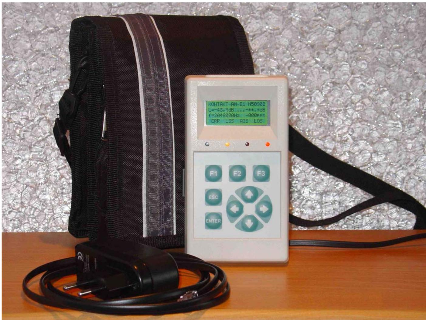
Внешний вид Анализатора ИКМ КОНТАКТ-AM-E1 в комплекте с сумкой-футляром и сетевым адаптером.
