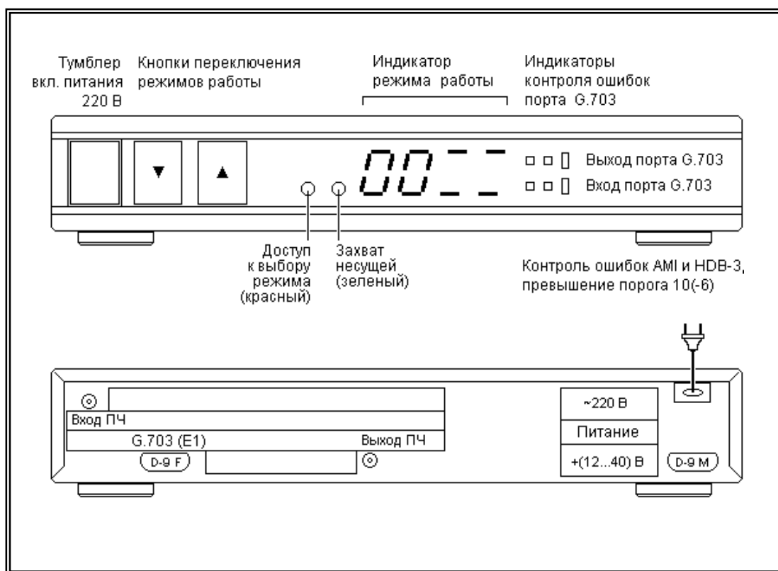
Рисунок 8. Вид панелей модема КОНТАКТ-11. Настольное исполнение, 1xE1, светодиодный индикатор.
