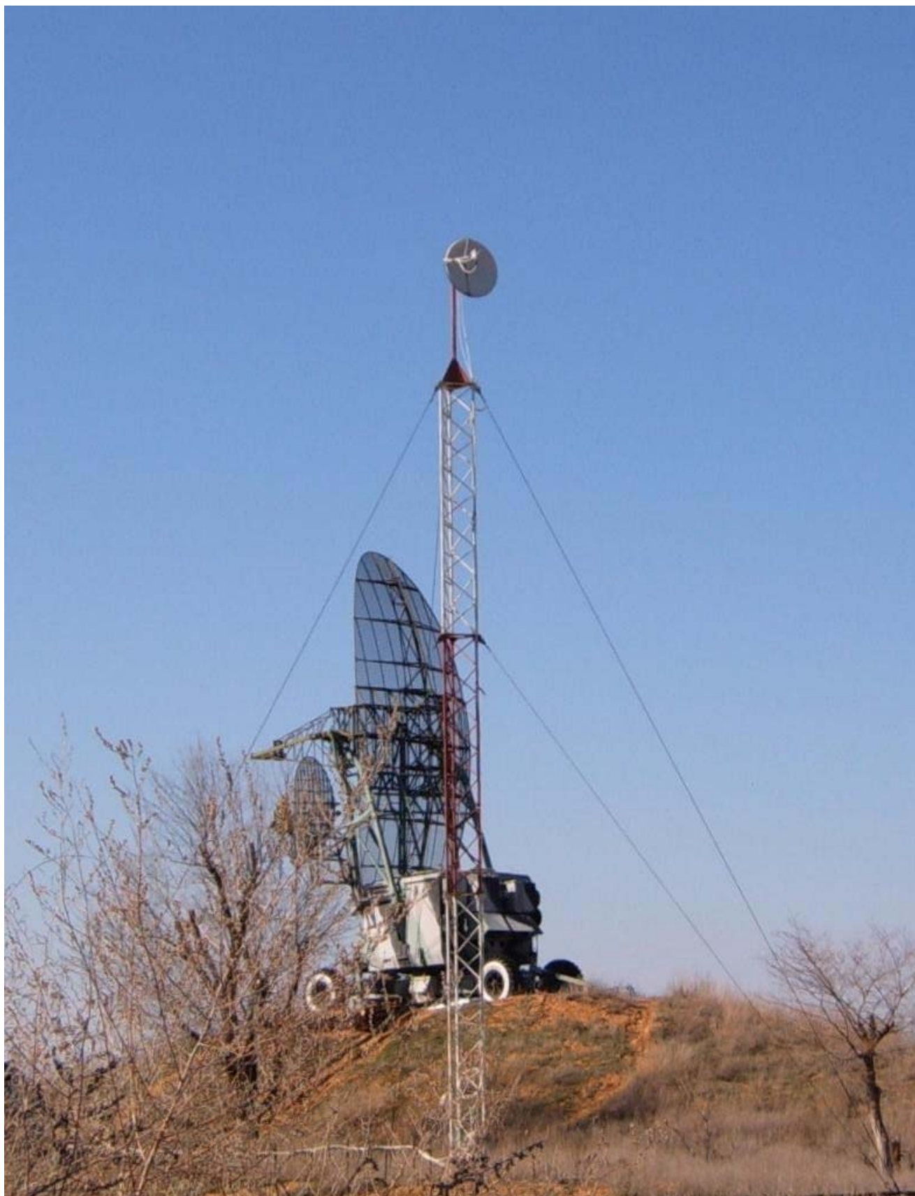
Рисунок 11. Пример оперативного развертывания радиотракта передачи КОНТАКТ-11 в полевых условиях.
