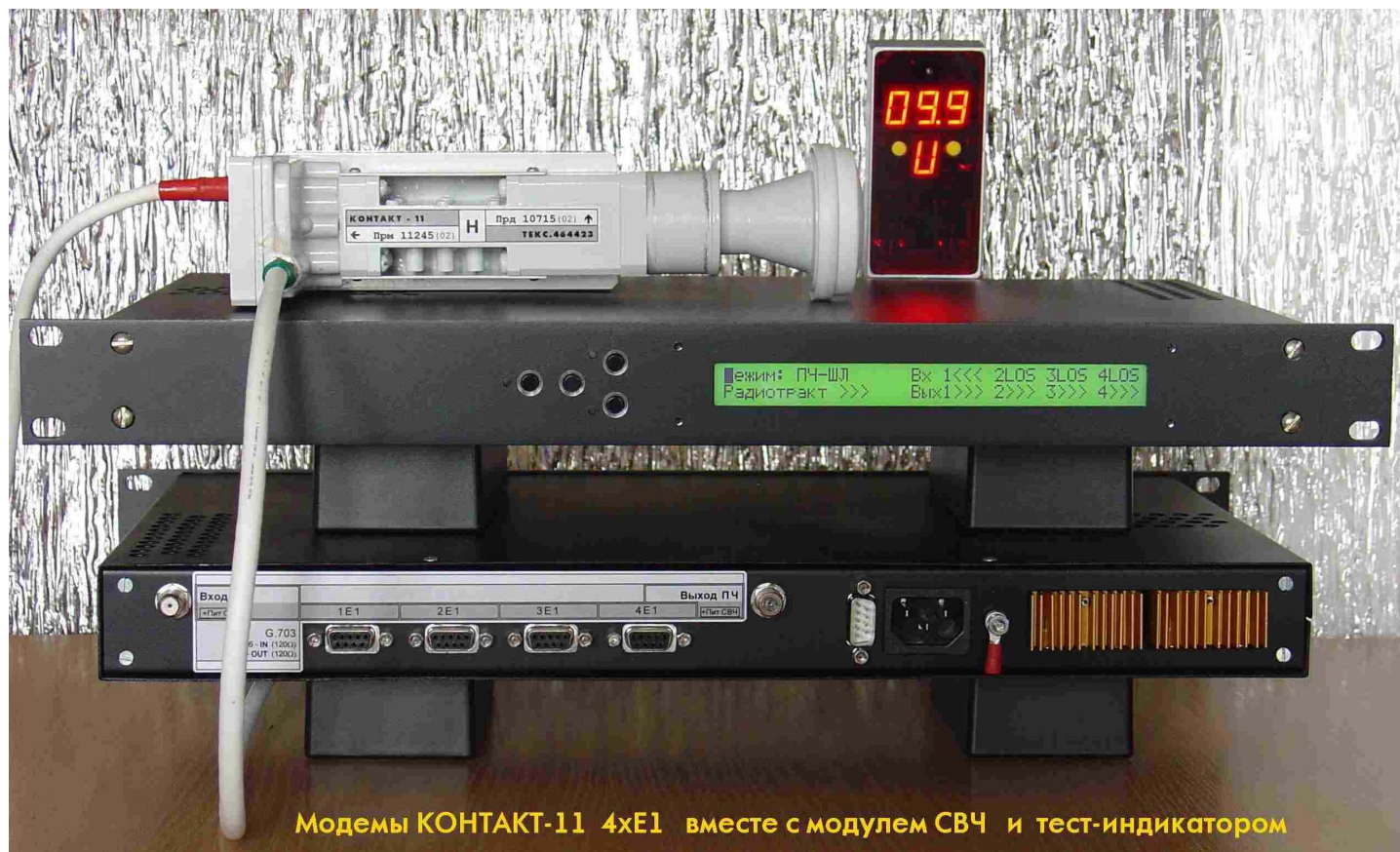
Рисунок 5. Внешний вид модемов КОНТАКТ-11 4xE1 в стойку 19" вместе с модулем СВЧ и тест-индикатором.
